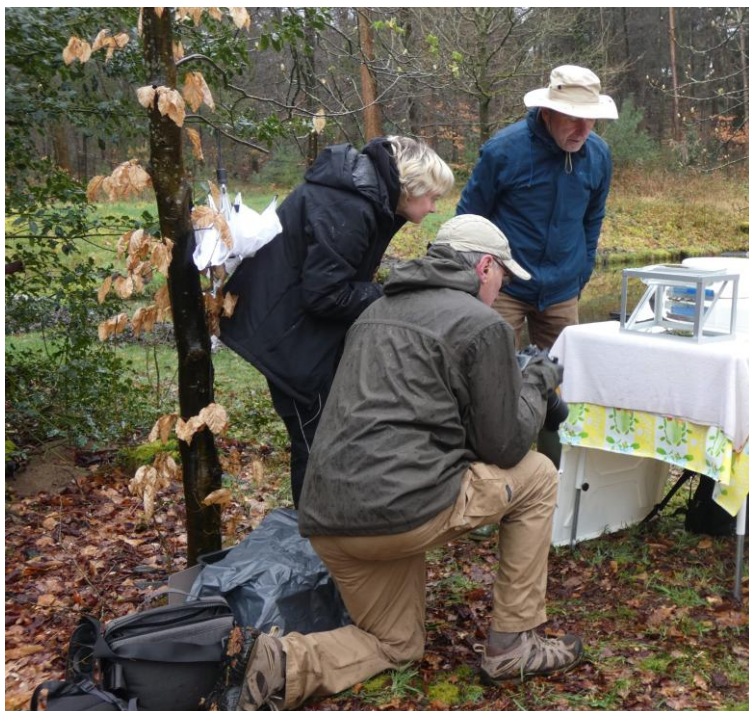
Frame met spiegel en bovenin een ovenschaaltje om salamanders van onderen te kunnen opmeten en te fotograferen.
